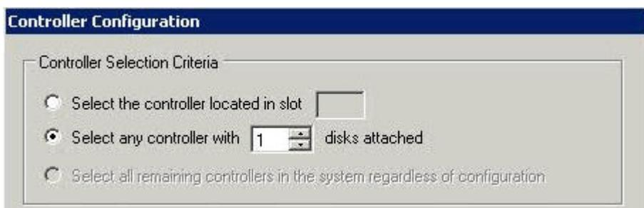
Figure 99. Configuration RAID dynamique
