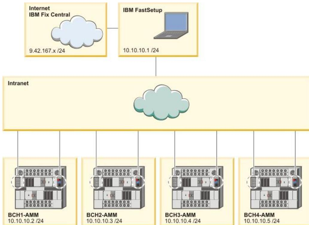
*Figure 1 : Câblage réseau de BladeCenter H*
