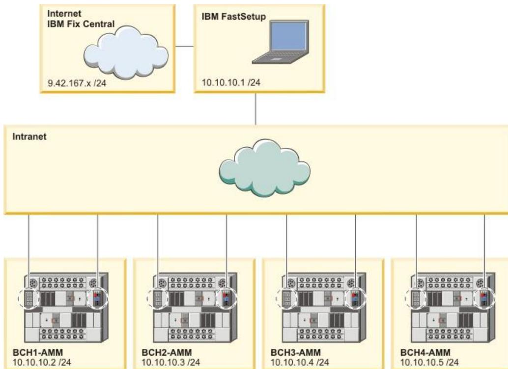
*Abbildung 1: BladeCenter H-Netzverkabelung*
