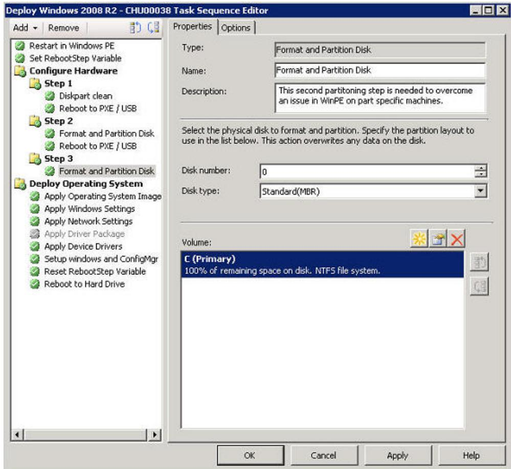
Figura 115. Acción *Format and Partition Disk* (Formatear y crear particiones en el disco)
