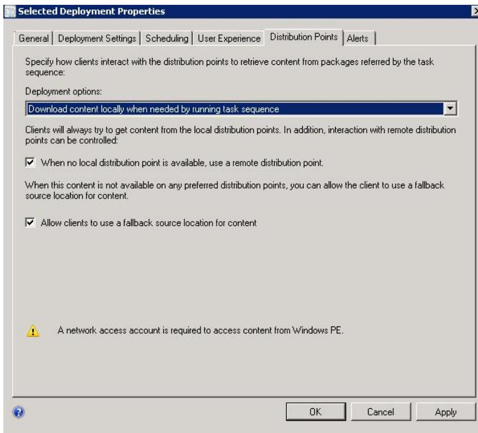
Figura 69. Propiedades del despliegue, pestaña Distribution Points (Puntos de distribución)
