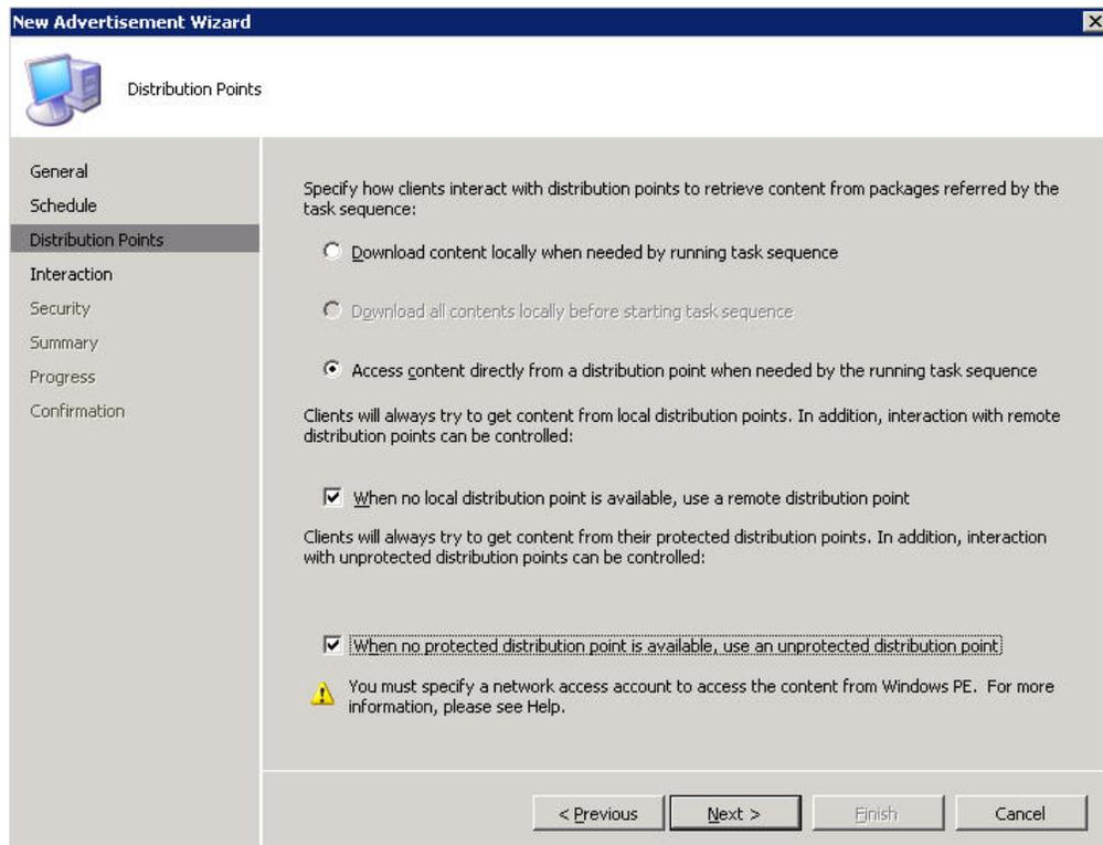
Figura 76. Especificación de las opciones de los puntos de distribución
