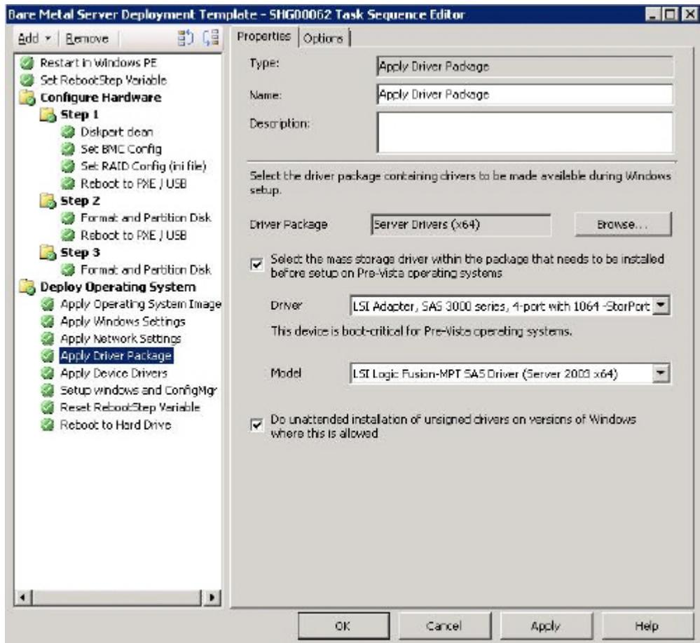
Figura 33. Valores de la opción Apply Driver Package (Aplicar paquete de controladores)
