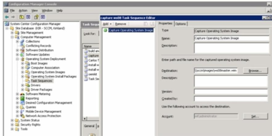
Figura 39. Edición de la secuencia de tareas de captura del SO para identificar la carpeta compartida
