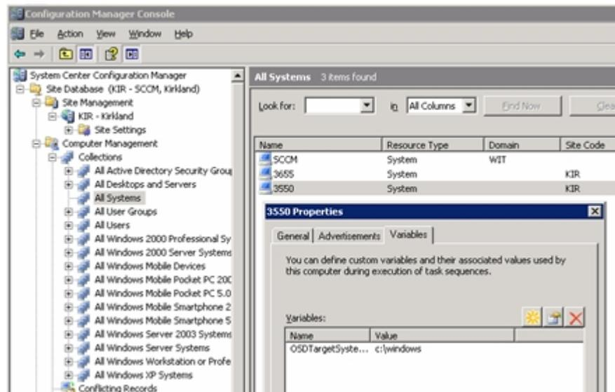
Figura 36. Definición de la ubicación del sistema operativo en el servidor de destino
