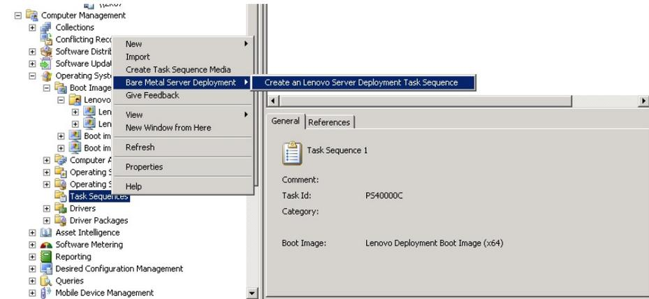
Figura 28. “Menú Create a Lenovo Server Deployment Task Sequence” (Crear una secuencia de tareas de despliegue del servidor Lenovo)
