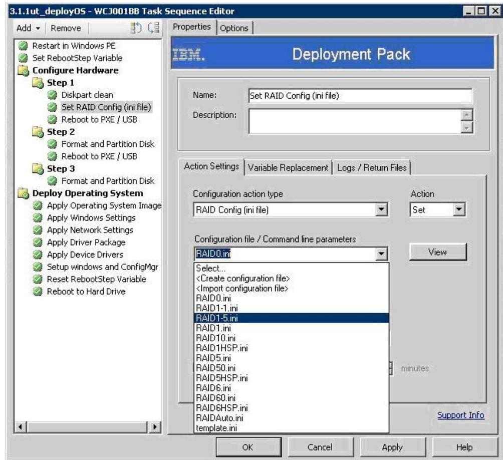
Figura 93. Edición de la tarea Set RAID Config (ini file) (Establecer config. RAID (archivo ini))
