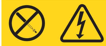
Des niveaux dangereux de tension, courant et électricité sont présents dans les composants qui portent cette étiquette. Aucune pièce de ces composants n'est réparable. Si vous pensez qu'ils peuvent être à l'origine d'un incident, contactez un technicien de maintenance.
