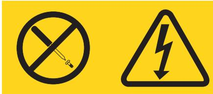
**Qualquer componente que contenha esta etiqueta possui voltagem, correntes e níveis de energia perigosos. Nenhuma peça localizada no interior desses componentes pode ser consertada. Se você suspeitar de um problema em uma dessas peças, entre em contato com um técnico de manutenção.**
