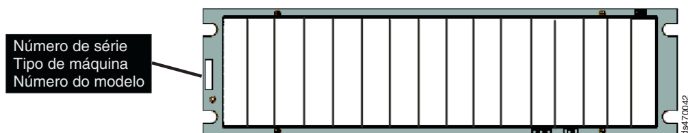
Figura 12. Exemplo de local do número de série, tipo de máquina e número de modelo do DS5020.
