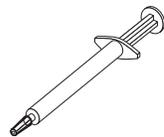
注：注射器上的每一刻度表示 0.01 毫升。如果油脂正确施用，那么注射器中将剩余大约一半油脂（0.22 毫升）。
