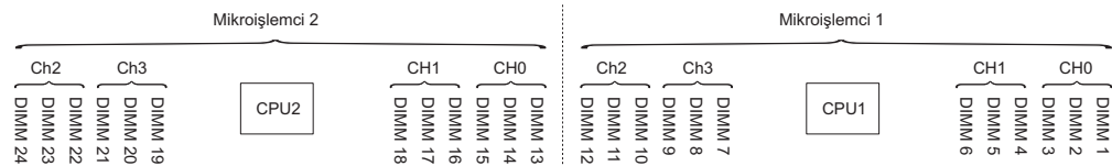
Şekil 1. Bellek kanalı arabirim düzeni
