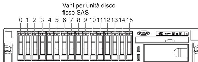
L'ID SAS per ciascun vano è stampato sulla parte anteriore del server, sopra ad ogni vano.
