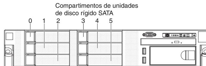
**LED de atividade da unidade de disco rígido:** Cada unidade de disco rígido tem um LED de atividade. Quando esse LED está piscando, indica que a unidade está sendo utilizada.
