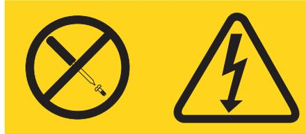
Voltagens, correntes e níveis de energia perigosos estão presentes dentro de qualquer componente que tenha esta etiqueta. Não há peças que possam ser consertadas no interior desses componentes. Se você suspeitar de um problema com alguma dessas peças, entre em contato com um técnico de manutenção.
