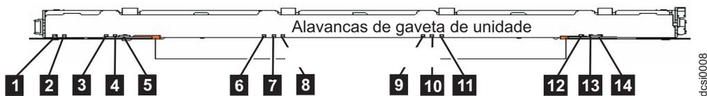
Figura 56. LEDs da gaveta de unidade
