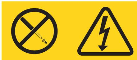
Voltagens, correntes e níveis de energia perigosos estão presentes dentro de qualquer componente que tenha essa etiqueta afixada. Não existem peças que podem ser consertadas no interior do dispositivo. Se você suspeitar de um problema com alguma dessas peças, entre em contato com um técnico.
