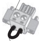
Extraiga el puente si se ha instalado
