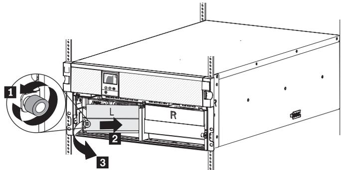
3. Lösen Sie die Rändelschraube an der rechten Akkualterung **1**, schieben Sie die Halterung nach links **2**, drehen Sie die Halterung heraus **3** und entfernen Sie sie anschließend.
