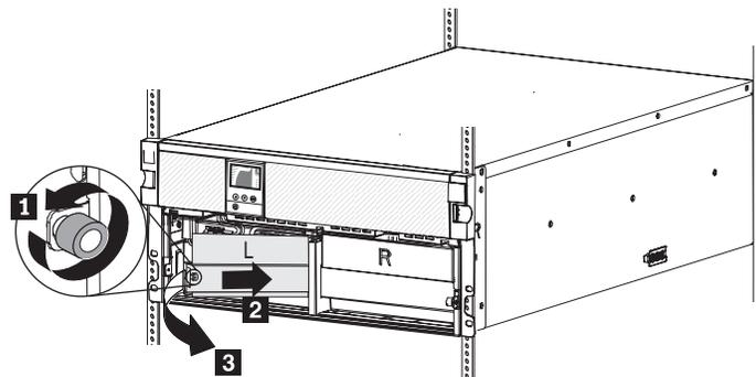
3. Lösen Sie die Rändelschraube an der rechten Akkuhalterung **1**, schieben Sie die Halterung nach links **2**, drehen Sie die Halterung heraus **3** und entfernen Sie sie anschließend.
