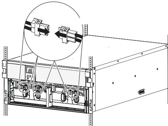
**Anmerkung:** Bei dieser Verbindung kann es zu einer kurzen Lichtbogenbildung kommen. Dies ist normal und führt nicht zu einer Beschädigung der Einheit oder zu einem Sicherheitsproblem.
