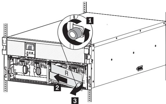
4. Trennen Sie alle drei internen Akkuanschlüsse und legen Sie die Anschlüsse beiseite.
