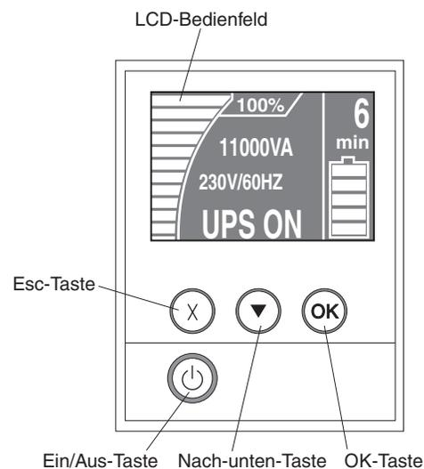
Die USV verfügt über eine grafische LCD-Anzeige und einer Hintergrundbeleuchtung in zwei Farben. Durch die Standardhintergrundbeleuchtung erscheint die Anzeige mit weißem Text und blauem Hintergrund. Die Anzeige blinkt, wenn Alarmer aktiv sind.
