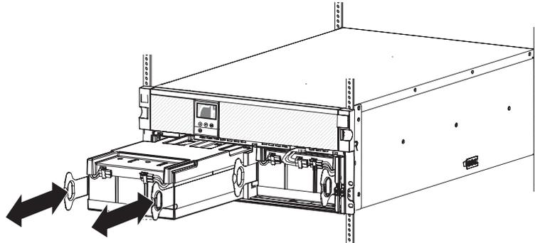
6. Entfernen Sie das rechte interne Akkumodul. Verwenden Sie mit den drei erforderlichen Personen die Plastikzungen, um das rechte Akkumodul vollständig aus der Position zu ziehen, und führen Sie es der Wiederverwertung zu bzw. entsorgen Sie es als Sondermüll.
