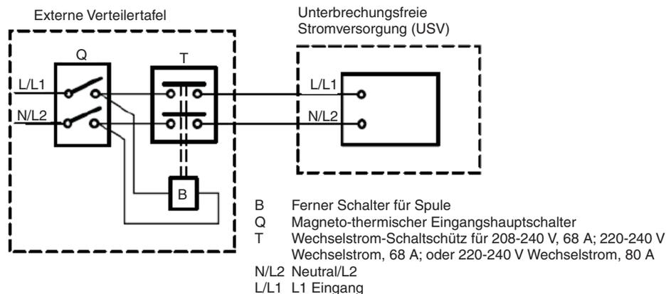
7. Schließen Sie die Eingangs- und Massekabel an den Anschlussblock an, wie in der folgenden Abbildung gezeigt und wie in Tabelle 4 beschrieben.
