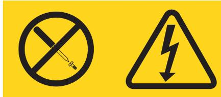
Des niveaux dangereux de tension, courant et électricité sont présents dans les composants qui portent cette étiquette. Aucune pièce de ces composants n'est réparable. Si vous pensez qu'ils peuvent être à l'origine d'un incident, contactez un technicien de maintenance.
