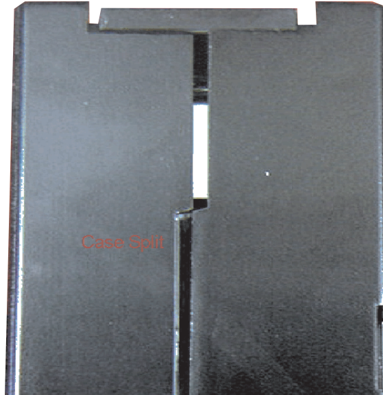
Şekil 6. Kartuşun ek yerindeki boşlukların denetlenmesi
