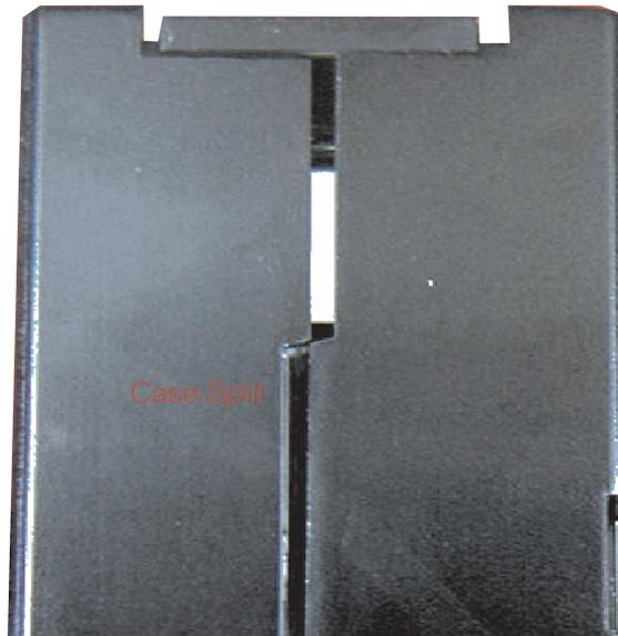
Abbildung 6. Kassette auf Lücken an der Naht prüfen
