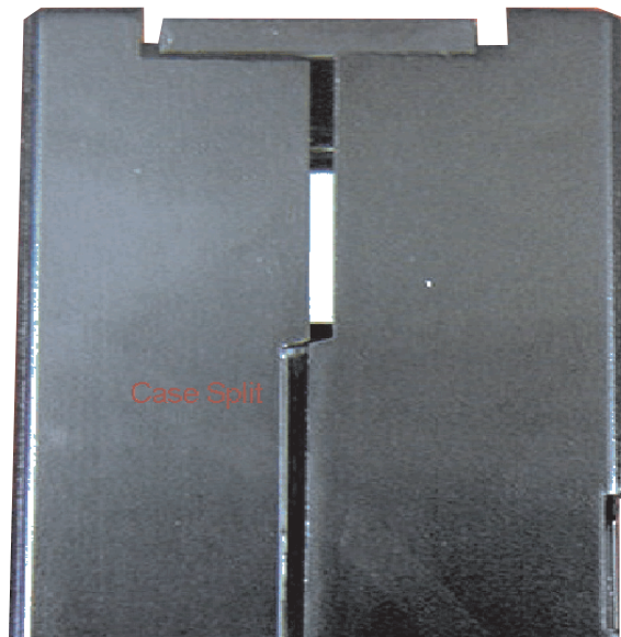
Figure 6. Recherche de fissures dans les joints d'une cartouche
