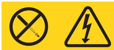
All'interno di ogni unità su cui è apposta sono presenti tensioni, livelli di corrente e di energia pericolosi. All'interno di queste unità non sono presenti parti soggette a manutenzione. Se si sospetta la presenza di un problema in una di queste parti, rivolgersi ad un tecnico dell'assistenza IBM.
