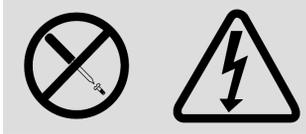
**Gefährliche Spannung, Strom und Energieniveaus befinden sich in allen Komponenten mit diesem Aufkleber. Im Inneren dieser Komponenten befinden sich keine Teile, die gewartet werden müssen. Wenden Sie sich an einen Wartungstechniker, wenn Sie ein Problem mit einem dieser Teile vermuten.**
