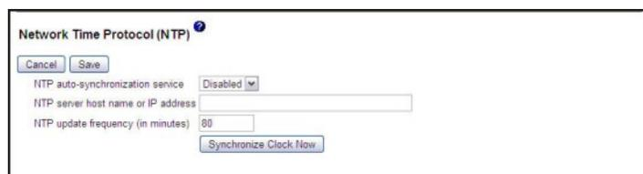
4. Sous **Network Time Protocol (NTP)**, vous pouvez sélectionner l'un des paramètres suivants :
