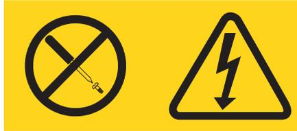
Voltagens, correntes e níveis de energia perigosos estão presentes dentro de qualquer componente que tenha esta etiqueta. Não existem peças que podem ser consertadas no interior do dispositivo. Se você suspeitar de um problema com alguma dessas peças, entre em contato com um técnico.
