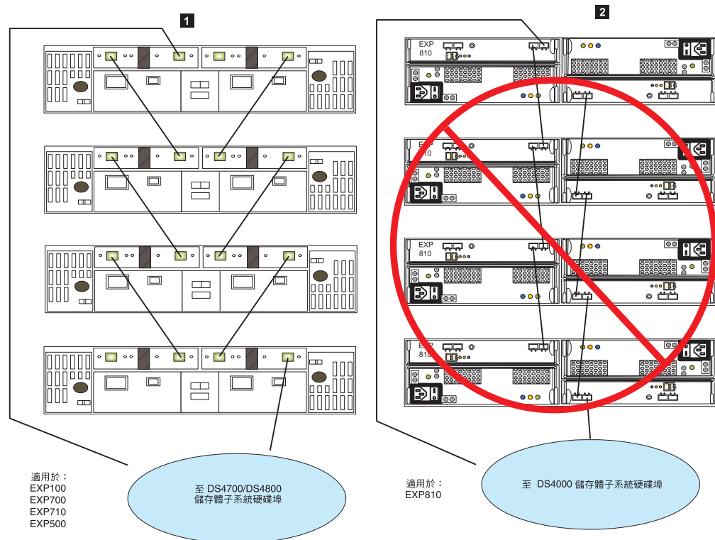
圖 38. 適用於連接儲存裝置的替代纜線迴圈方法
