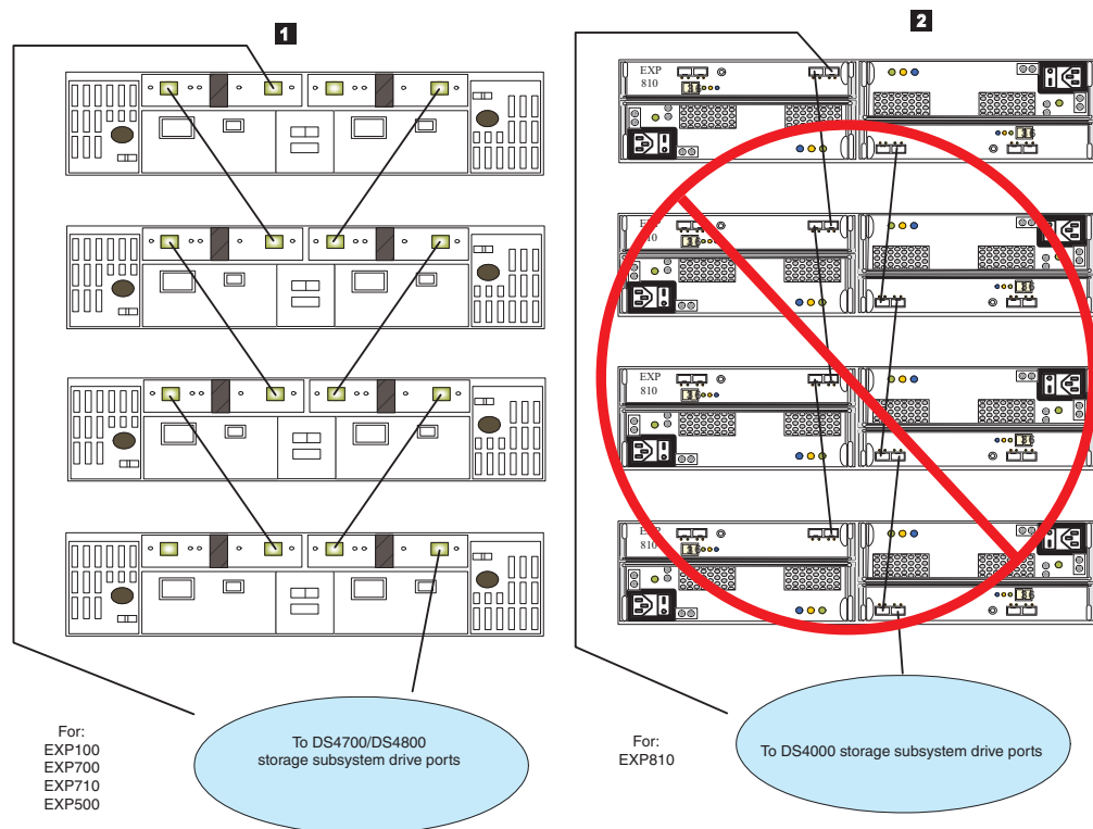
图 38. 连接存储设备的备用电缆环路方案
