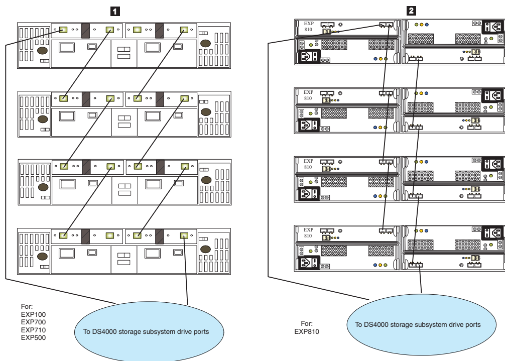
图 36. 用于连接存储设备的最佳电缆环路方案
