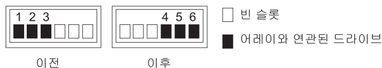
그림 21. 1개 스토리지 격납장치의 빈 베이를 사용하여 정의된 어레이를 재정렬하는 우수 사례
