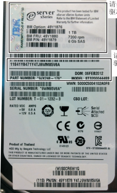
图 91. IBM 全息图标签示例
