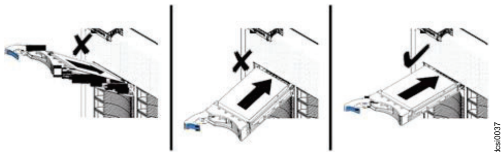
图 79. 将硬盘驱动器插入驱动器插槽
