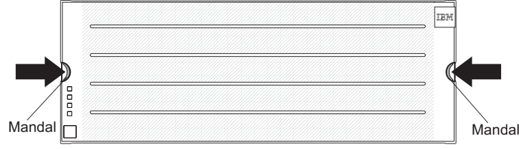
Şekil 84. Ön çerçeveyi çıkarma
