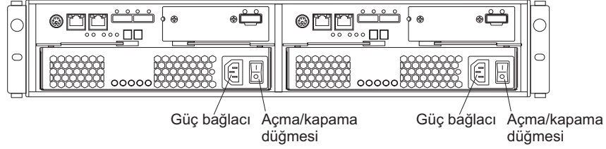
Şekil 9. AC güç kaynağı bileşenleri
