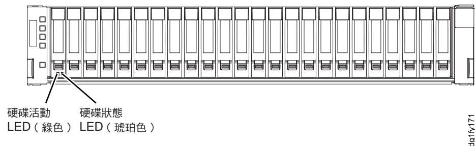
圖 99. DS3524 儲存體子系統和 EXP3524 儲存體機體硬碟 LED
