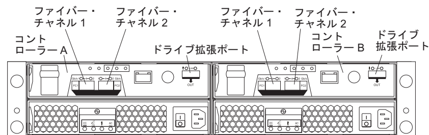
図 14. DS3400 ストレージ・サブシステムのポートとコントローラー
