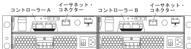
図 37. デュアル・コントローラー DS3400 上のイーサネット・コネクタの位置
