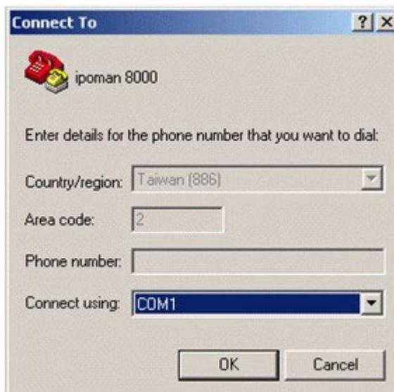
3. En la lista **Conectar usando** (Connect using), seleccione el puerto COM que está conectado a la PDU. Pulse **OK**. Se abre la ventana Propiedades (Properties).
