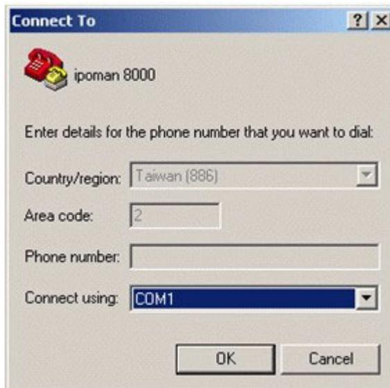
3. 「接続方法」で、PDU に接続する COM ポートを選択します。「OK」をクリックします。該当の「プロパティ」ウィンドウが開きます。
