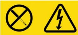
Gefährliche Spannung, Strom und Energieniveaus befinden sich in allen Komponenten mit diesem Aufkleber. Im Inneren dieser Komponenten befinden sich keine Teile, die gewartet werden müssen. Wenden Sie sich an einen Wartungstechniker, wenn Sie ein Problem mit einem dieser Teile vermuten.
