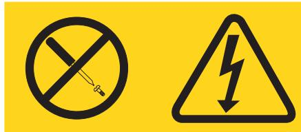
En el interior de cualquier componente que lleve esta etiqueta hay niveles peligrosos de voltaje, corriente y energía. Dentro de estos componentes no existe ninguna pieza que requiera mantenimiento. Si sospecha que hay un problema relacionado con una de estas piezas, póngase en contacto con un técnico de servicio.
