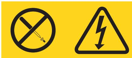
Esta etiqueta indica um dispositivo que apresenta tensão, corrente eléctrica e outros níveis de energia perigosos. Nenhum componente existente no interior deste dispositivo requer manutenção por parte do utilizador. Se suspeitar da ocorrência de um problema relacionado com um dos referidos componentes, contacte um técnico de assistência.
