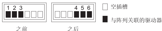
图 21. 重新排序已定义阵列的最佳做法是使用一个存储机柜中的空托架
