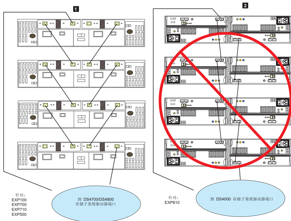
图 38. 连接存储设备的备用电缆环路方案
