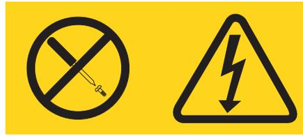
任何贴有该标签的组件内部都存在危险的电压、电流和能量级别。这些部件内没有可维护的部件。如果您怀疑某个部件有问题，请联系技术服务人员。
