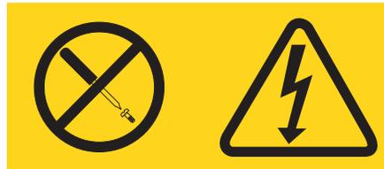
Qualquer componente que contenha esta etiqueta possui voltagem, correntes e níveis de energia perigosos. Não há peças que possam ser consertadas no interior desses componentes. Se você suspeitar de um problema com alguma dessas peças, entre em contato com um técnico de manutenção.
