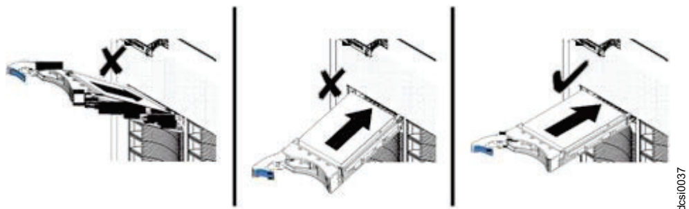
圖 79. 將硬碟插入硬碟插槽
