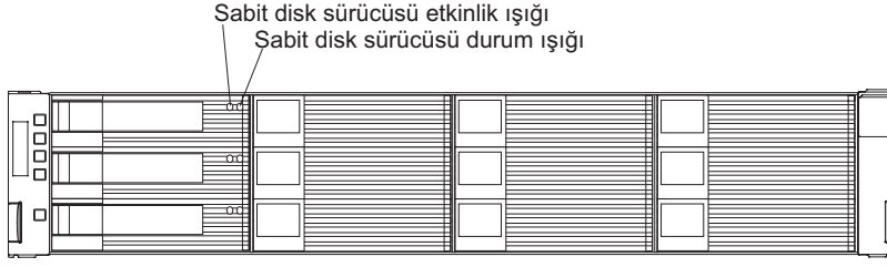
Şekil 5-11. DS3512 depolama altsistemi ve EXP3512 depolama kasası sürücüsünün ışıkları
