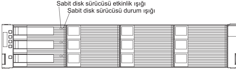
Şekil 5-10. DS3512 depolama altsistemi ve EXP3512 depolama kasası sürücüsünün ışıkları
