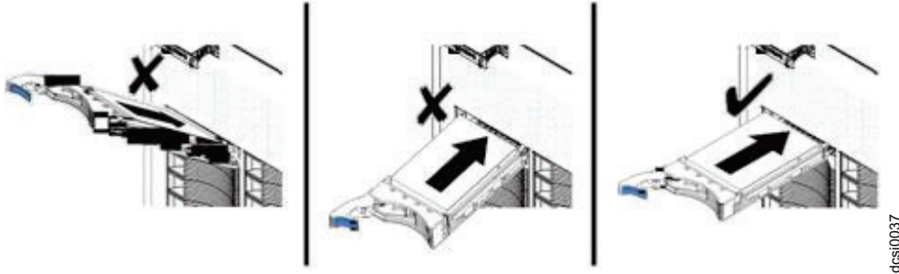
Şekil 5-14. Sürücü yuvasına sabit disk sürücüsü takma
