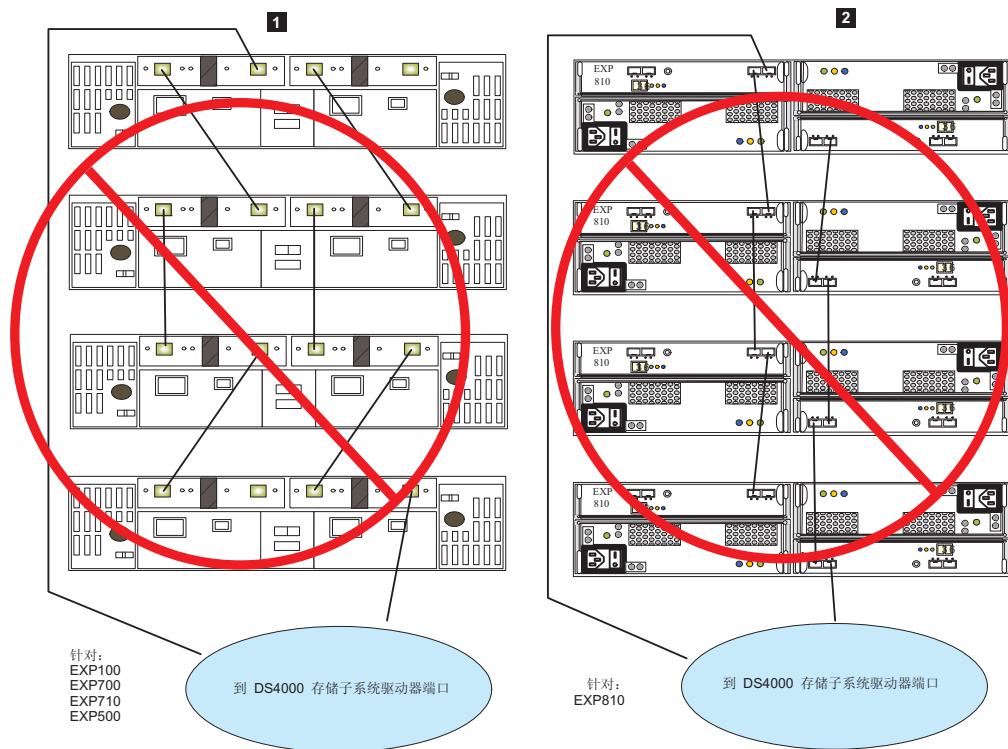
图 39. 不受支持的存储设备连接电缆环路方案（第 2 个，共 2 个）
