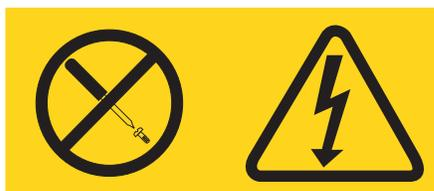
**Voltagens, correntes e níveis de energia perigosos estão presentes dentro de qualquer componente que tenha esta etiqueta. Nenhuma peça localizada no interior desses componentes pode ser consertada. Se você suspeitar de um problema com uma dessas peças, entre em contato com um técnico de manutenção.**
