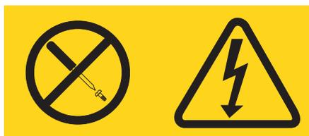
Qualquer componente que contenha esta etiqueta possui voltagem, correntes e níveis de energia perigosos. Nenhuma peça localizada no interior desses componentes pode ser consertada. Se você suspeitar de um problema com uma dessas peças, entre em contato com um técnico de manutenção.
