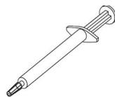
注：0.01 毫升是注射器上的一格刻度。如果油脂点放正确，那么注射器中将剩下约一半（0.22 毫升）的油脂。
