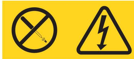
任何贴有该标签的部件内部都存在危险的电压、电流和能量级别。这些部件内没有可维护的部件。如果您怀疑某个部件有问题，请联系技术服务人员。
