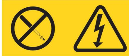
Des niveaux dangereux de tension, courant et électricité sont présents dans les composants qui portent cette étiquette. Aucune pièce de ces composants n'est réparable. Si vous pensez qu'ils peuvent être à l'origine d'un problème, contactez un technicien de maintenance.
