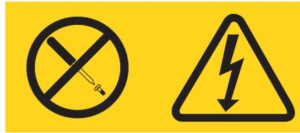
Qualquer componente que tiver esta etiqueta possui voltagem, correntes e níveis de energia perigosos. Nenhuma peça localizada no interior desses componentes pode ser consertada. Se você suspeitar de um problema com uma dessas peças, entre em contato com um técnico de manutenção.
