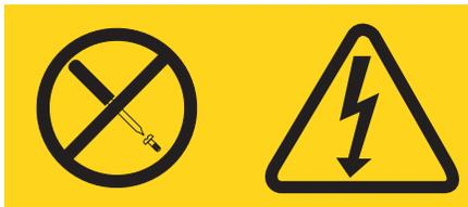
Níveis de energia, corrente e voltagem perigosos estão presentes dentro de qualquer componente que tenha essa etiqueta anexada. Nenhuma peça localizada no interior desses componentes pode ser consertada. Se você suspeitar de um problema com uma dessas peças, entre em contato com um técnico de manutenção.
