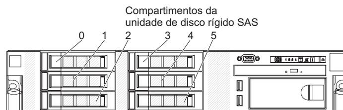
Figura 9. Vista frontal com unidade de disco rígido de 3,5 pol.
