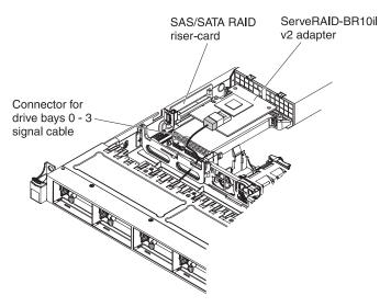
Figure 46. ServeRAID-BR10il v2 adapter cable connection
