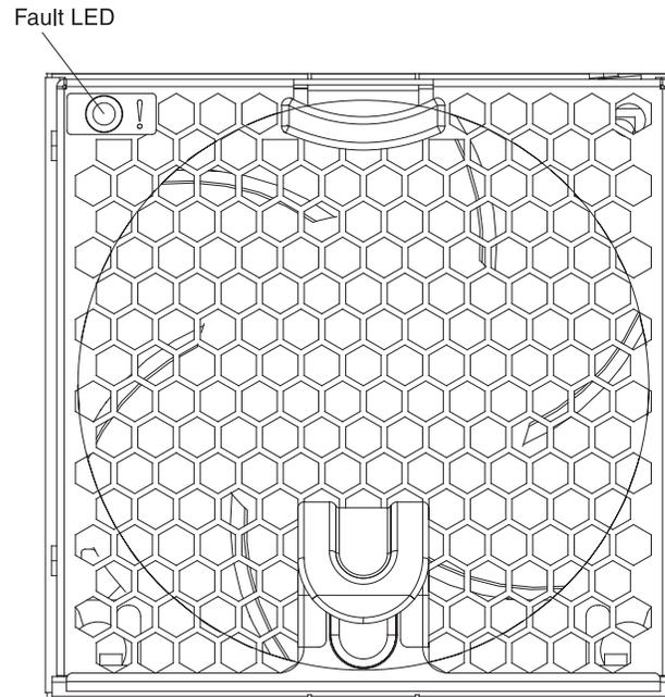
*Figure 12. Fan module*
