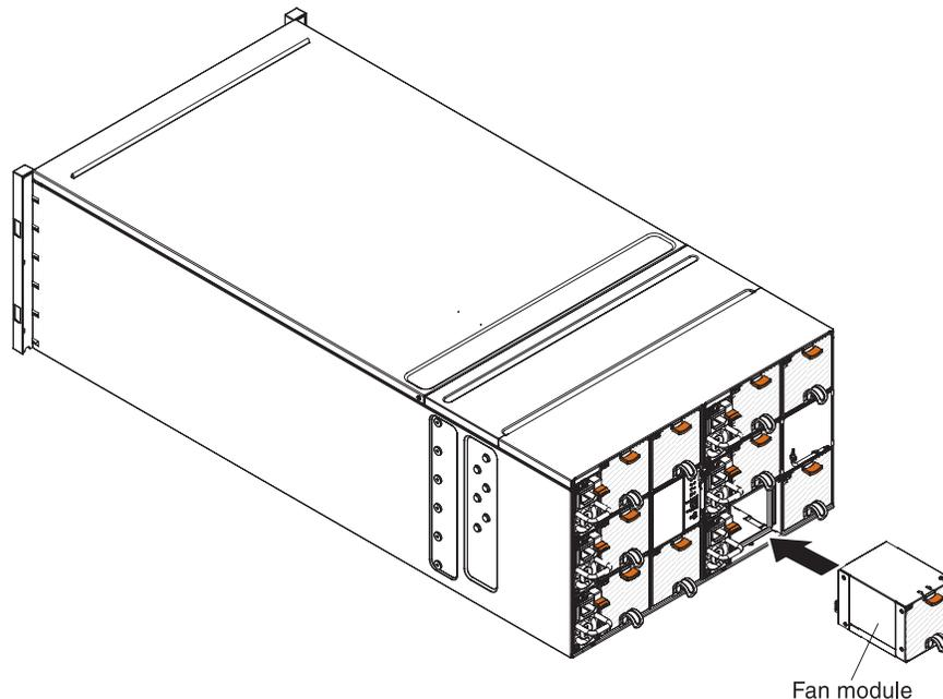
Figure 17. Installation of a fan module
