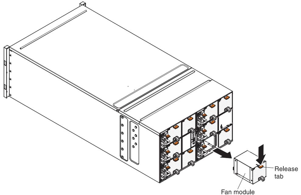
Figure 16. Removal of a fan module
