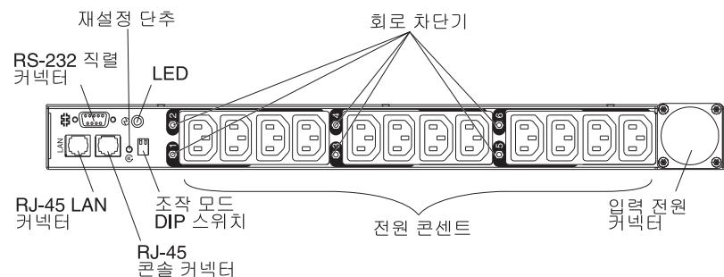
다음 그림에서는 DPI C19 PDU+ 및 DPI C19 3상 PDU+ 앞면의 구성요소와 제어를 보여 줍니다.
