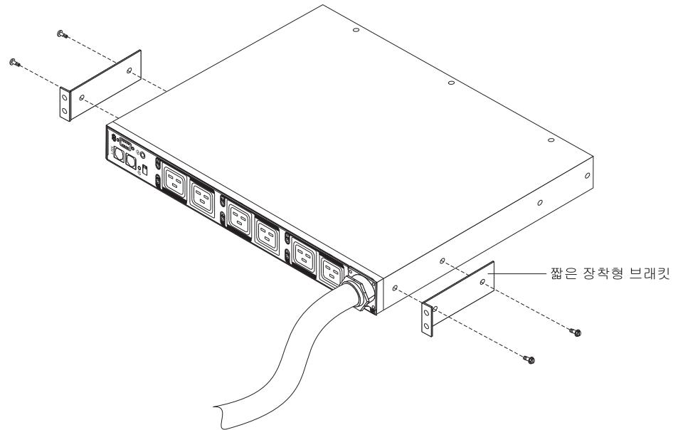
2. 긴 장착형 브래킷을 PDU 뒷면에 있는 구멍에 맞추고 풀립 방지 와셔가 있는 M3 냄비 머리 나사를 브래킷당 두 개 사용하여 브래킷을 PDU에 연결하십시오. 랙 장착 컷과 함께 제공되는 나사를 사용하십시오.
