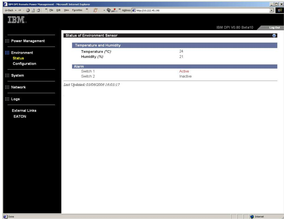
5. 접점 폐쇄의 상태가 표시되기 전에 PDU 웹 인터페이스에서 이 피처를 구성하고 사용 가능하게 설정해야 합니다. 환경을 누른 다음 구성 누르십시오. 환경 센서의 구성 페이지가 열립니다.
