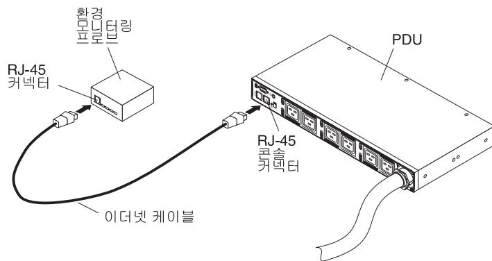
3. PDU에 네트워크 연결이 있는지, 전원 코드가 연결되어 있는지, PDU의 전원이 켜져 있는지 확인하십시오. 환경 모니터링 프로브는 PDU에 의해 자동으로 인식됩니다.
