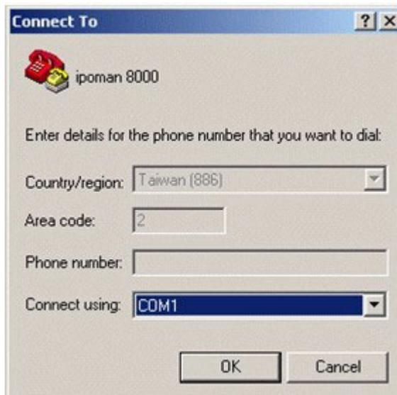
3. Na lista **Conectar usando**, selecione a porta COM conectada à PDU. Clique em **OK**. A janela Propriedades se abre.
